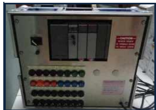
Allen Bradley SLC 5/03
